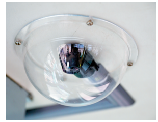
全線載客電車已安裝閉路電視，錄影路面狀況及車長表現。
